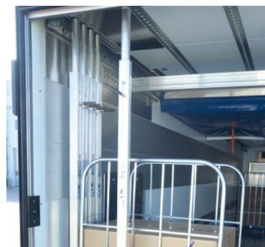
**Magazine\* für senkrechte und waagerechte Ladungssicherungsbalken** im Heck und unter der Decke vereinfachen das Handling, die schnelle Ladungssicherung und sorgen für einen sicheren Transport.
