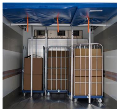
**Senkrechte Teleskopbalken\*** auf ganzer Länge einfach und schnell im Airline-Boden zur Ladungssicherung fixiert. Hohe Scheuerleisten schützen den Innenraum.
