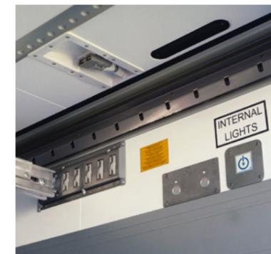
**Innenraumbedienelement für Lichtschalter\*** und **OptiLevel Höhenverstellung\*** zur Rampenanpassung beim Be- und Entladen.
