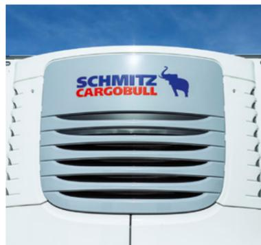
**Elektrische Kältemaschine S.CUE** von Schmitz Cargobull erlaubt das Befahren von Zero-Emission-Zones. Stromversorgung erfolgt über die angekoppelte Sattelzugmaschine, oder CEE-Anschluss.
