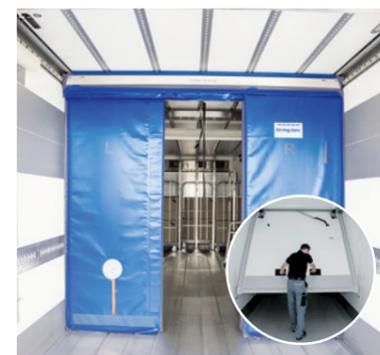
**MultiTemp-Transporte mit schwenkbaren Trennwänden\***, die im Innenraum auf ganzer Länge verschoben werden können. Entweder aus flexiblen Thermoelementen oder als festes Element aus FERROPLAST®.
