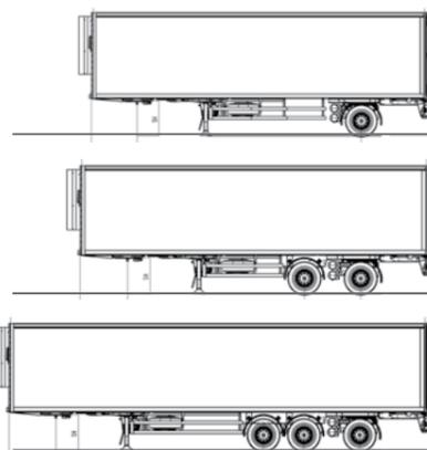
**Bis zu 36 Palettenstellplätze:** Sieben Aufbau-Achskombinationen für die optimale Kombination aus Nutzlast und Wendigkeit im City-Einsatz.
