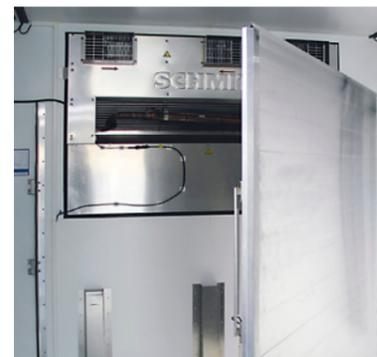
**Klappbare Zirkulationswand** für einfache Reinigung. Kasten-Abstandsprofile für optimale Luftzirkulation.
