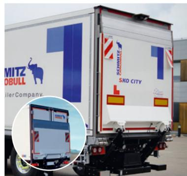
**Ladebordwand\*** als Heckabschluss. Standard ist eine zweiflügelige Hecktür mit vorgeklappter oder unterfahrbarer Ladebordwand\*.
